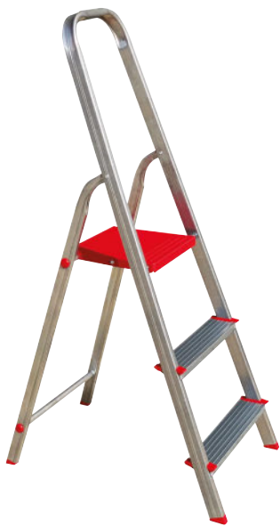
Escalera aluminio Habitex Basic Perfil delantero aluminio 40x20 mm. Peldaños acero galvanizado 80 mm. Norma EN 131. 2428C03B...
